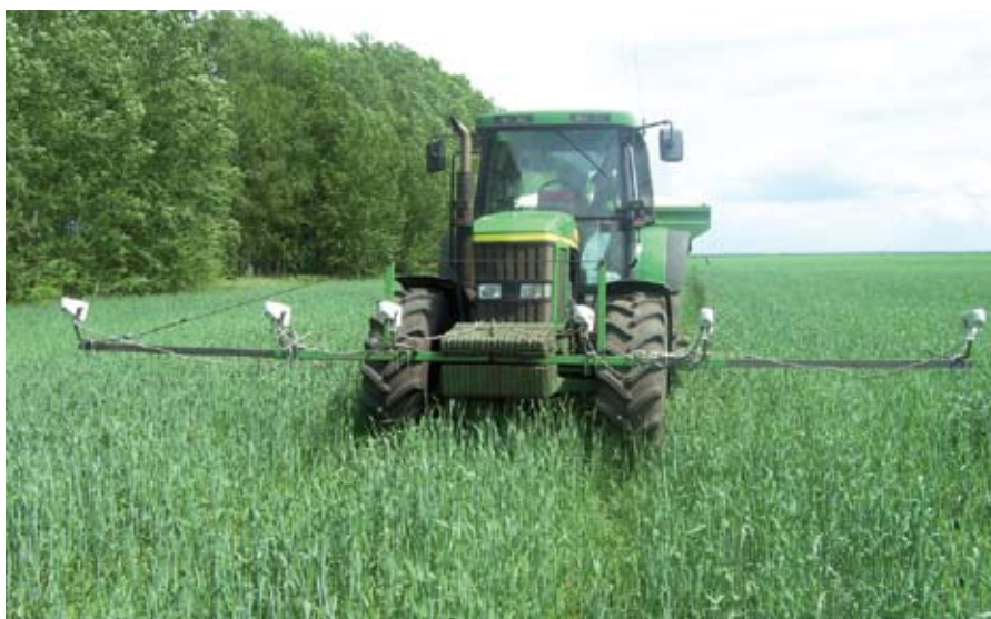
Сенсор GreenSeeker RT 200, установленный на трактор «Джон Дир»
