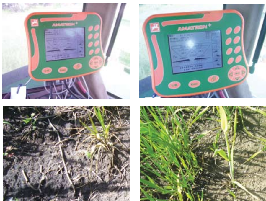
Рис. 4. Показания разных доз внесения на бортовом компьютере «Аматрон+» и соответствующее им количество удобрений на почве при проведении on-line внесения азота
