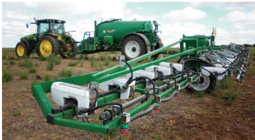
Автоматизированная система точного опрыскивания WeedSeeker монтируется на опрыскиватель и предусматривает оперативное дифференцированное внесение СЗР
