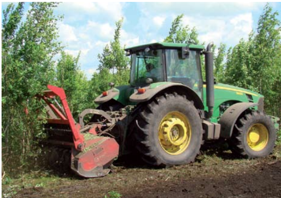
Рекультивация полевых угодий в хозяйстве: при измельчении берез используется древесная фреза Ahwi
