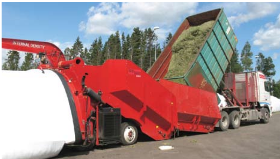
Заполнение пластиковых рукавов зеленой массой для хранения и использования на биогаз
