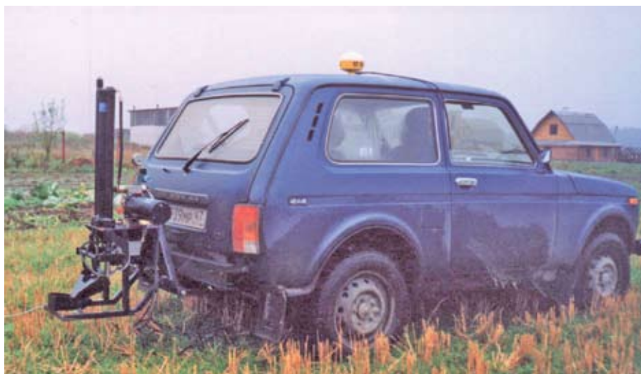
На этапе сбора данных нами используется мобильный автоматизированный комплекс для создания электронных карт полей и агрохимического обследования
