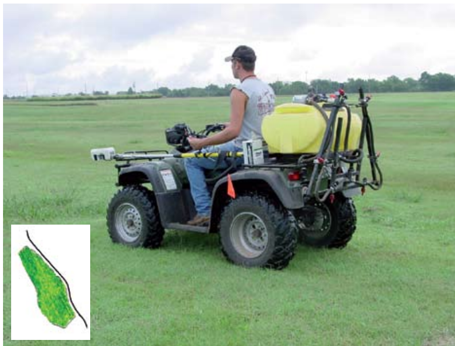
Рис. 3. Односенсорная система GreenSeeker RT100 может быть установлена на квадроцикл
