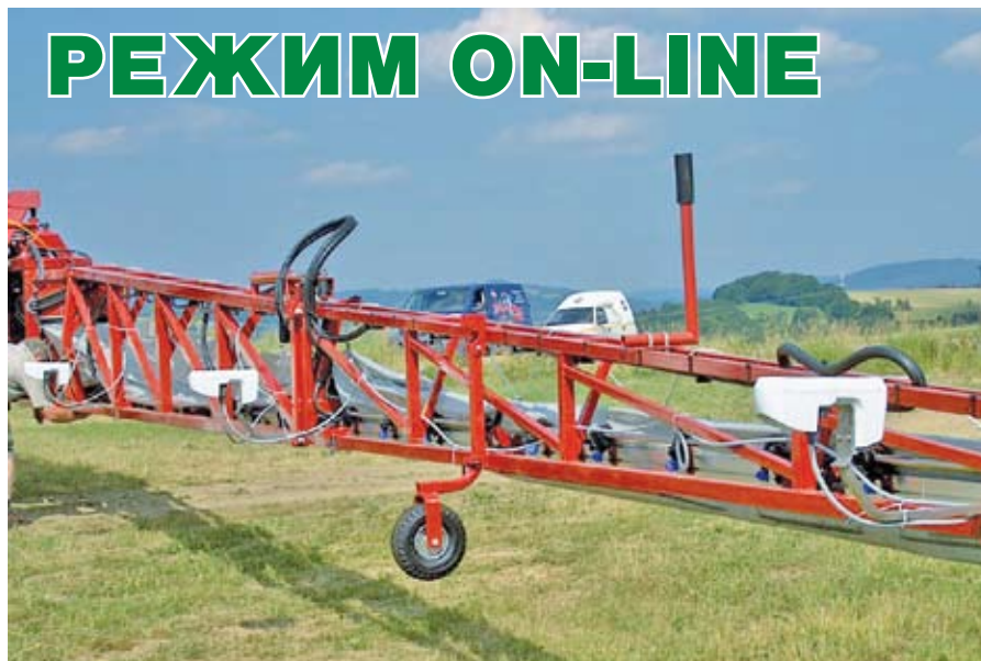
Рис. 5. Во время движения опрыскивателя по полю датчики GreenSeeker измеряют растительный покров, одновременно происходит формирование электронной карты индекса NDVI и карты норм внесения удобрений
