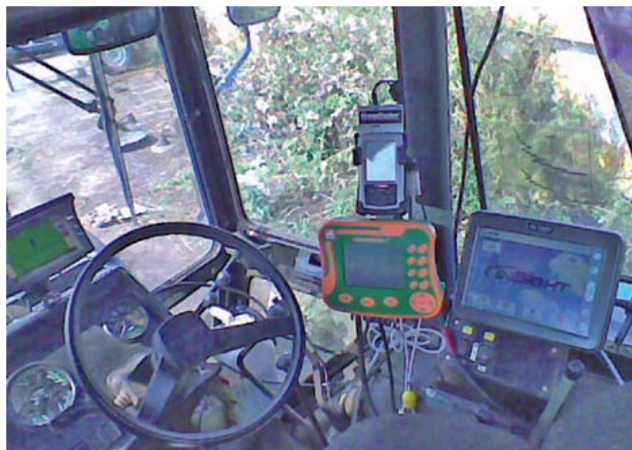
Рис. 4. Полевой компьютер и контроллер легко монтируются в кабине трактора
