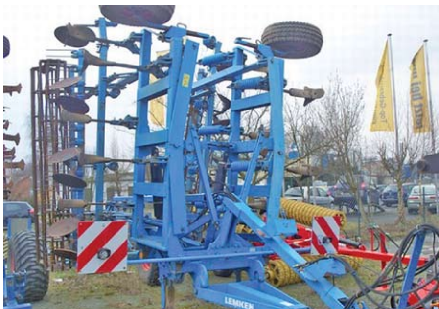
Дисковый культиватор Smaragd 9/600 KU (A), первая рабочая зона включает в себя сменные стрельчатые лапы, смещенные полевые диски, выравниватели соломы и трубчатые катки. Вторая зона включает в себя уплотняющий каток и выравнивающие элементы
