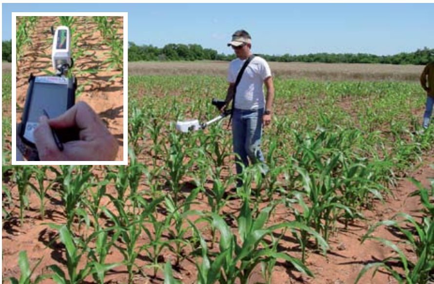
GreenSeeker Hand Held Optical Sensor Unit предназначен для «ручного» исследования полей. В комплектацию прибора входят: сенсорный датчик, штанга, полевой компьютер и аккумулятор
