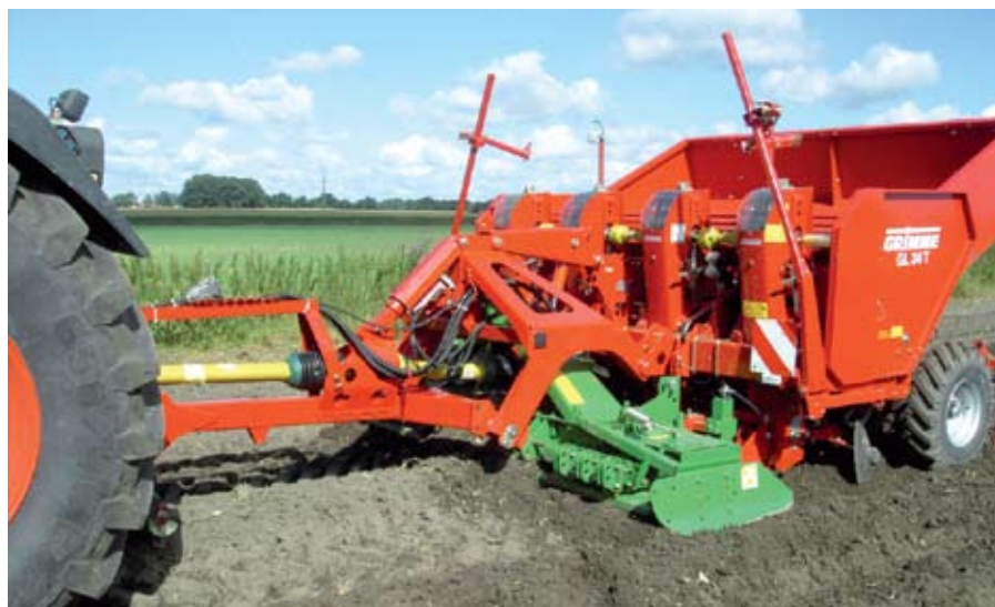
Прямая мульчированная посадка картофеля осуществляется в посадочное ложе, подготовленное осенью с помощью комбинации Grimme GL 34
