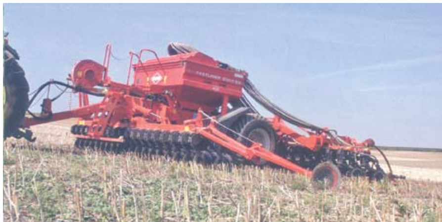
Прямой посев озимой пшеницы в рапсовую стерню с помощью сеялки Kuhn Fastliner SD 6000
